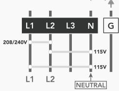
NOTE: L3 TERMINAL USED FOR 3 PHASE ONLY. SEE BACK SIDE OF LOWER FRONT PANEL FOR 3 PHASE CONVERSION INSTRUCTIONS.
